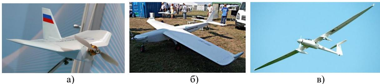
Рисунок 4.6 - БПЛА легкого (а), среднего (б) и тяжелого (в) классов
