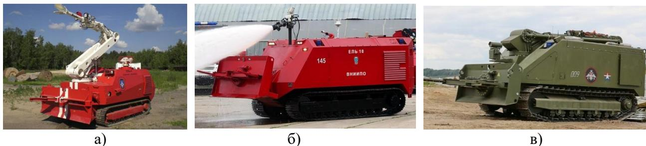
Рисунок 4.5 - Пожарные роботы тяжелого класса: а) Ель-4; б) Ель-10; в) Уран-14
