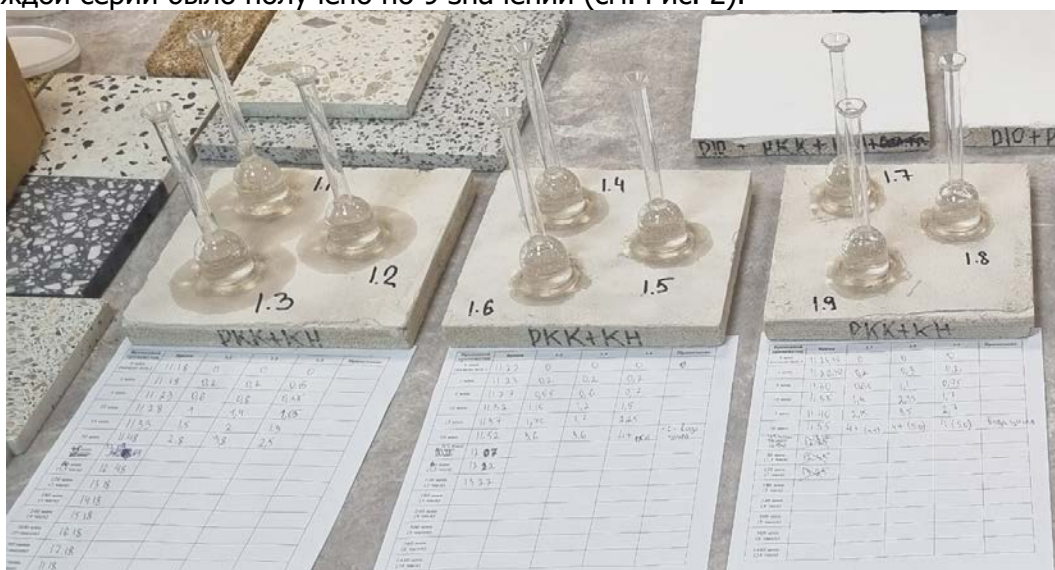
Рис. 2. Проведение испытания на определение водопоглощения
