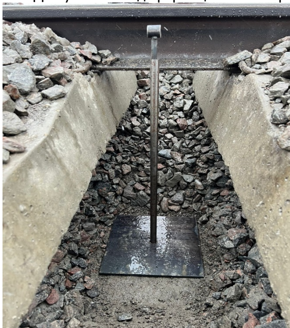
Рис. 4. Общий вид деформационной марки, устанавливаемой на основную площадку земляного полотна
