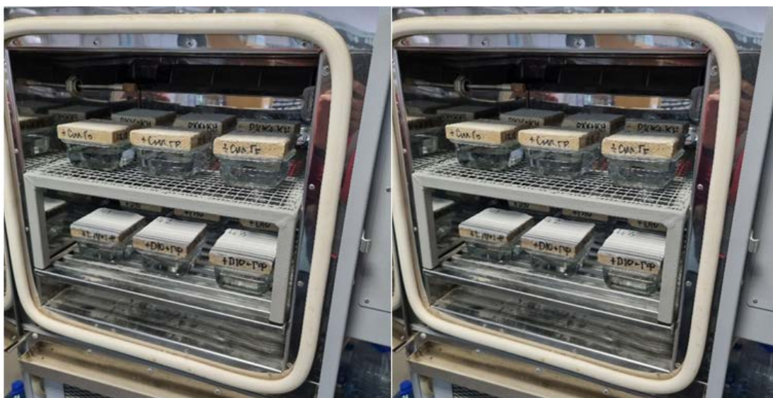
Рис. 1. Проведение испытания на паропроницаемость
