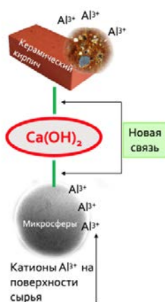
Рис. 2. Качественная схема образования новой связи между \text{Ca(OH)}_2 и катионами керамического сырья
