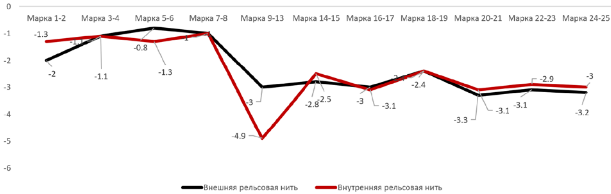
Рис. 8. Накопление остаточной деформации на экспериментальном участке
