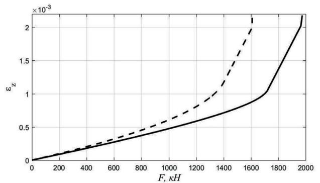
Рис. 2. Зависимость осевой деформации от нагрузки
