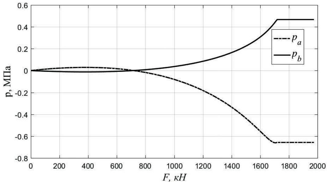
Рис. 3. Изменение контактных давлений в зависимости от величины нагрузки
