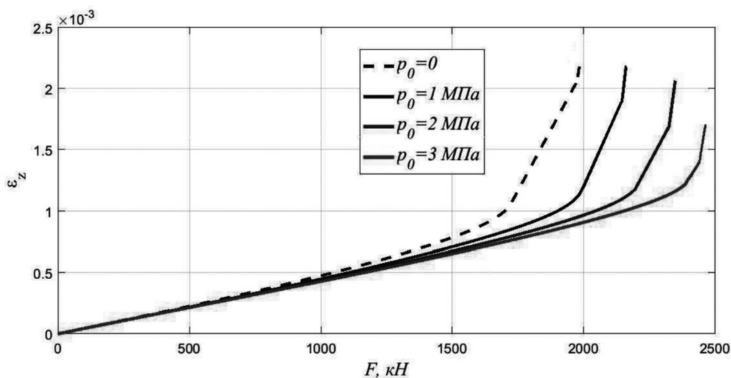
Рис. 4. Изменение осевой деформации в зависимости от нагрузки при различных уровнях предварительного напряжения
