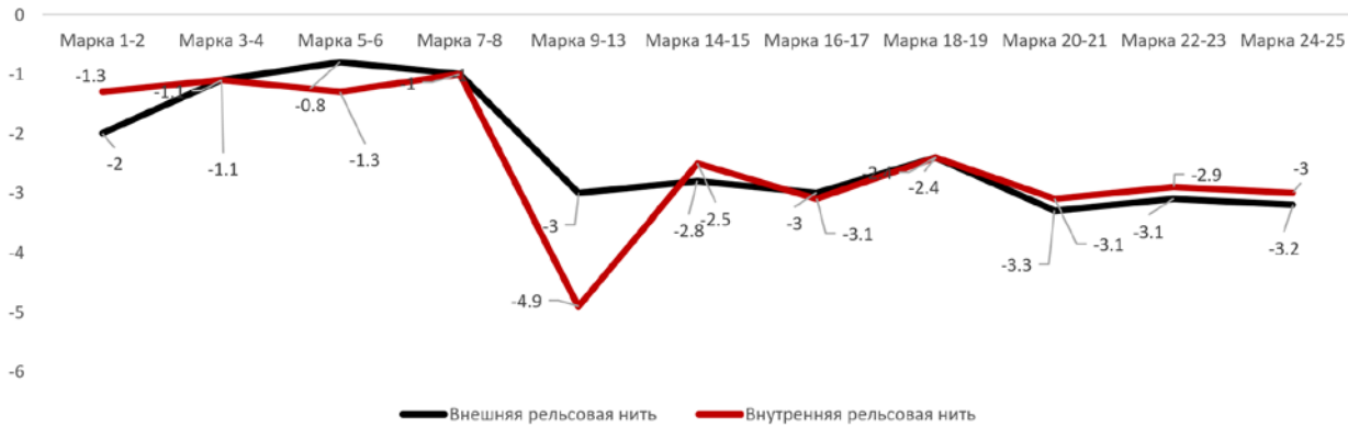
Рис. 8. Накопление остаточной деформации на экспериментальном участке
