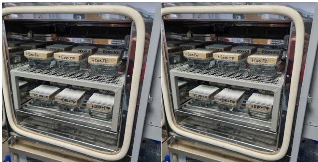
Рис. 1. Проведение испытания на паропроницаемость
