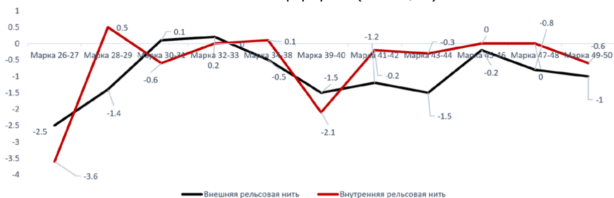
Рис. 7. Накопление остаточной деформации на контрольном участке
