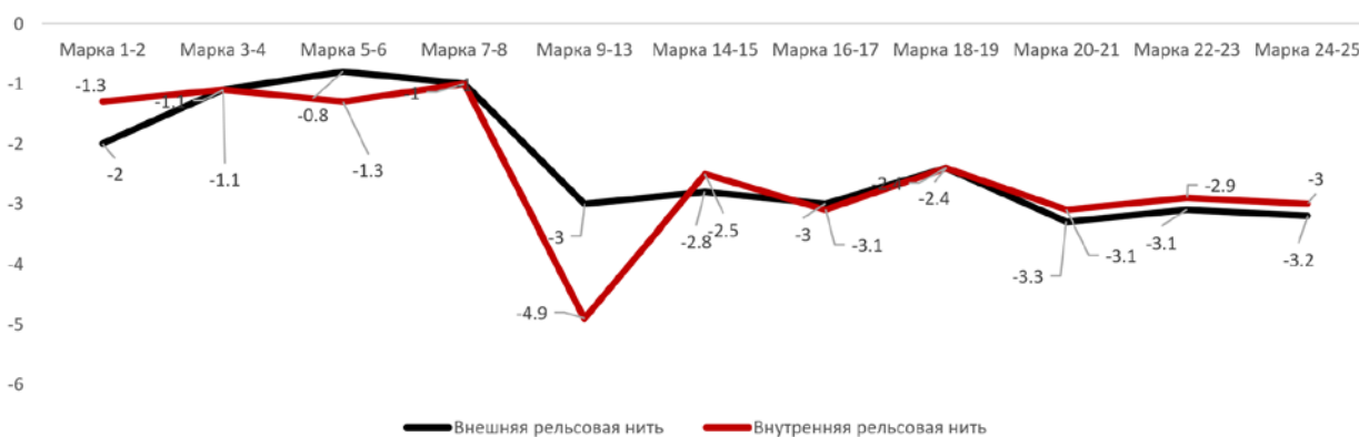
Рис. 8. Накопление остаточной деформации на экспериментальном участке
