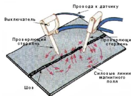
Рис. 4. Схема проведения магнитопорошкового метода.
