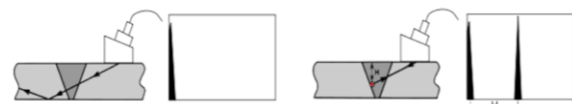
Рис. 3. Эхо метод - проверки сварного соединения. Сварное соединение без дефекта – слева, с дефектом - справа.
