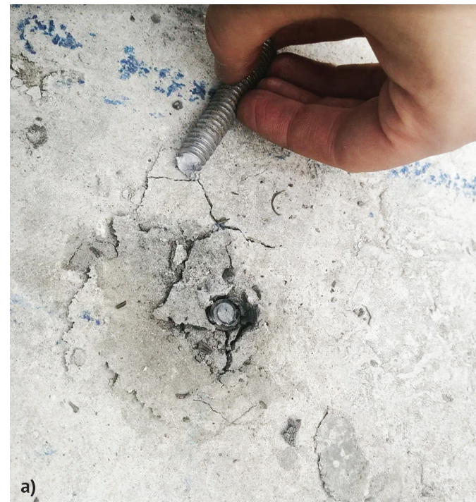
Рис. 8. Основные виды разрушения клеевого анкера: а) по телу анкерной шпильки (по стали), б) по клеевому составу (в зоне контакта зрелого бетона и клеевого состава)
