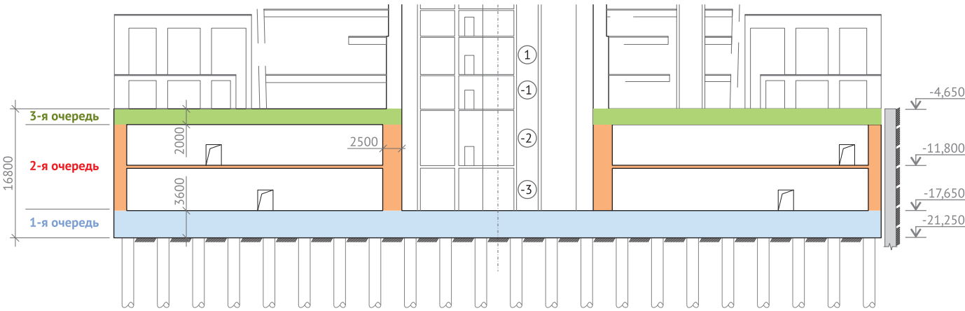
Рис. 2. Разрез коробчатого фундамента Fig. 2. Section of a box foundation
