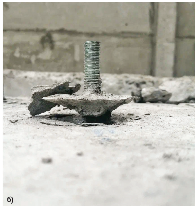
Рис. 8. Основные виды разрушения клеевого анкера: а) по телу анкерной шпильки (по стали), б) по клеевому составу (в зоне контакта зрелого бетона и клеевого состава)
