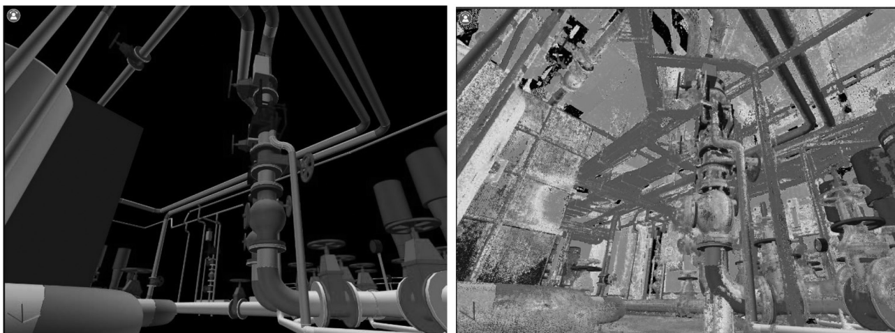
Рис. 7. Итоговый результат работы: а) модель; б) модель, совмещенная с эталонным облаком точек
