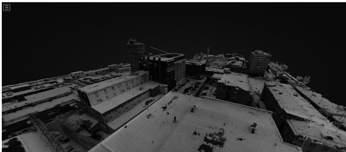
Рис. 1. Облако точек, полученное в результате обработки результатов фотограмметрии (аэрофотосъемка с БПЛА)
