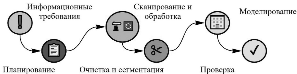
Рис. 4. Метод построения as-built BIM-модели
