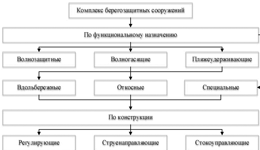
Рис. 2. Классификация схем берегозащитных сооружений
